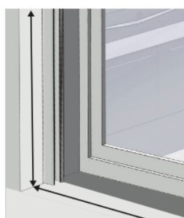
Medición hueco exterior
